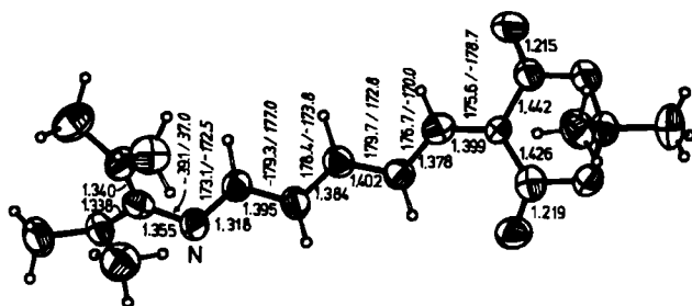
Abb. 1. ORTEP-Zeichnung (50proz. Wahrscheinlichkeit) eines Moleküls von 7a im Kristall. Das zweite unabhängige Molekül hat eine dazu etwa spiegelbildliche Konfiguration. Eingezeichnet sind die Torsionswinkel [°] für das abgebildete Molekül (kursiv: entsprechende Werte für das zweite Molekül) und die gemittelten Bindungslängen [Å]. Die mittleren Fehler der Mittelwerte betragen 0.004–0.005 Å. Das NCN-Fragment der Formamidiniumgruppe ist um 42° (im zweiten Molekül um 35°), die CCC-Ebene des heterocyclischen Acceptors um 5° (14°) gegen die durch Kleinstquadratmethoden ermittelte Ebene der Polyenke (NC 3 ) verdreht.
